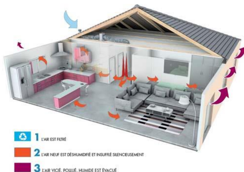
Figure 31 : VPH, ventilation centralisée par insufflation (EOLETEC)
