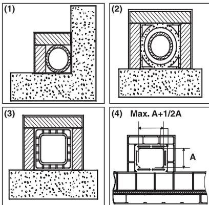
(1) Canna fumaria in acciaio AISI 316 con doppia camera isolata con materiale resistente a 400°C.
