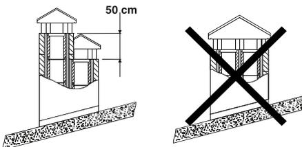
(1) En caso de conductos de humos colocados uno al lado de otro, uno deberá superar al otro como mínimo en  $50 \text{ cm}$ , para evitar traslados de presión entre los mismos.
