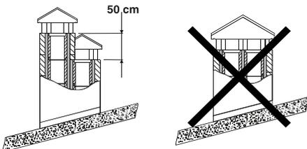
(1) No caso de condutas de fumos colocadas uma ao lado da outra, uma delas deverá ultrapassar a outra no mínimo em 50 cm, para evitar passagens de pressão entre os próprios cabos
