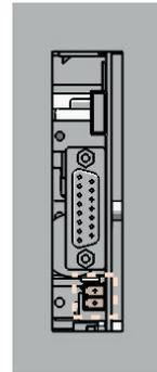
Si la commande de votre poêle-cheminée doit être prise en charge par un thermostat d'ambiance externe, vous devez raccorder ce dernier (1) à la place du pont de câble (2) monté en standard.
