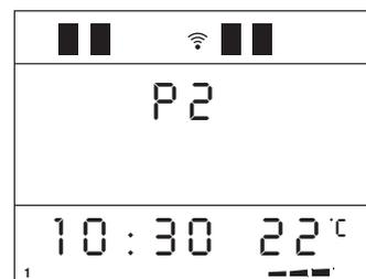
Si vous accédez au menu THERMOSTAT EXTÉRIEUR et si vous sélectionnez la mention « **MODULÂT** », dès l'atteinte de la température programmée sur le thermostat, la puissance du poêle passe de celle programmée par l'utilisateur à P1.
