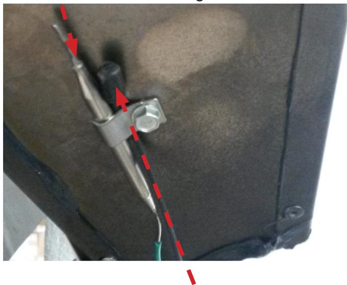
**B.** Le capteur de température situé sur le réservoir à granulés est activé à une température de 82 °C et en modulant automatiquement par palier de puissance. Si la température continue à augmenter, le thermorupteur (1) sera activé.
