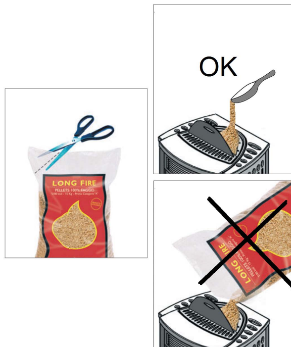
Fig. 13 Faire l'appoint en granulés, préférer une pelle pour charger que de vider le sac directement.
