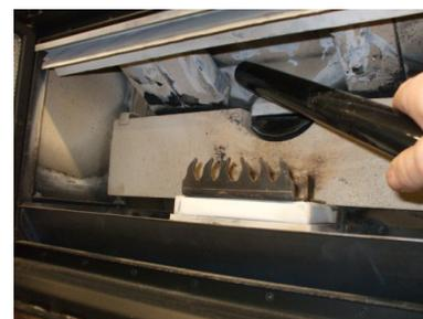
Fig. 48 - Nettoyage de la partie supérieure
