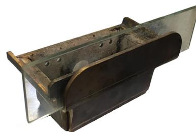
Fig. 43 - Positionnement du verre du creuset
