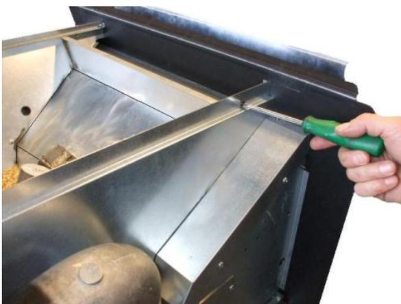
Fig. 61 - Devisser les vis de fixation carter
