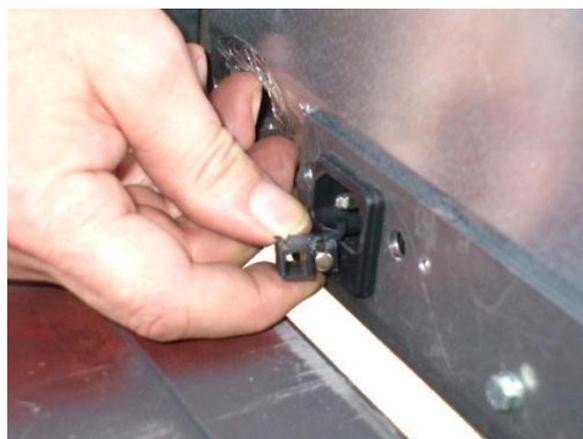
Fig. 66 - Substitution du fusible
