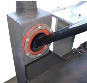
*Fig. 51 - Nettoyage du collecteur de fumées*
