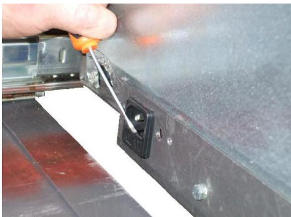
Fig. 65 - Enlèvement du fusible sur la prise électrique
