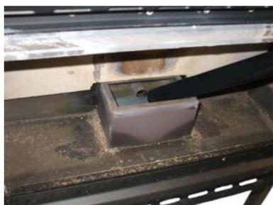
Fig. 46 - Nettoyage du logement du brasero
