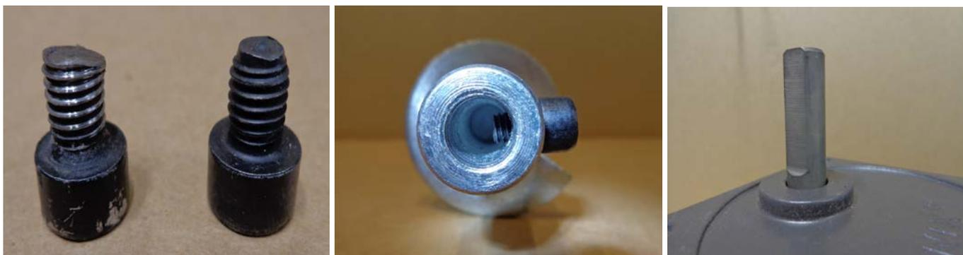
La photo de gauche ci-dessus montre deux vis de l'assemblage portant le repère n°4, la vis de droite est en bon état et celle de gauche est abimée et rognée suite à un début de bourrage dans la vis sans fin, il est inutile et inefficace d'essayer de la resserrer. Cette vis doit être changée par une vis neuve de type M6 X 10 mm.
