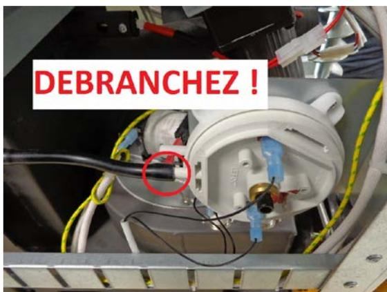
**Contrôle n° 4** – le pressostat peut être défectueux ou des connexions électriques sont mauvaises. Ce test doit être réalisé en dernier et seulement après avoir scrupuleusement suivi les instructions précédentes
