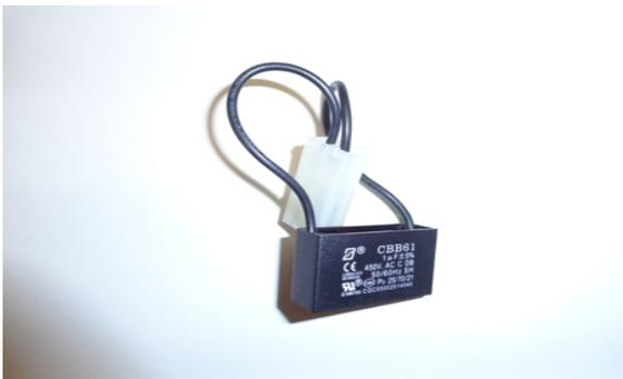
Condensateur qui est relié au connecteur blanc du moteur de vis sans fin. Ce condensateur est destiné à donner de la force au moteur (voir contrôle à effectuer ci-dessous)
