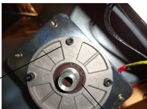
Vis de fixation de la flasque X4 vue de dessous.
