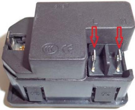
Contrôlez l'interrupteur général : après avoir débranché les deux cosses bleu et rouge, mesurez à l'aide d'un voltmètre que l'alimentation secteur 220v traverse bien celui-ci lorsqu'il est en position 1.
