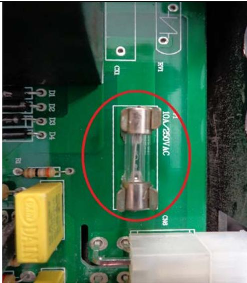
Contrôlez le fusible qui se situe à l'intérieur du boîtier de puissance à l'aide d'un ohmmètre. Ce fusible est sous un capuchon en plastique bleu transparent.
