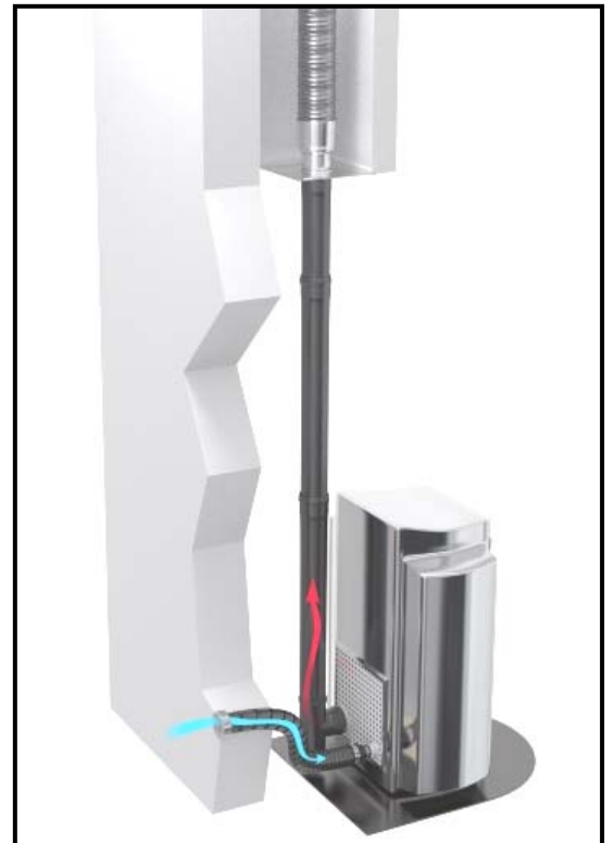
Figure 13 - Configuration séparée en rénovation de conduit existant (poêles à granulés)
