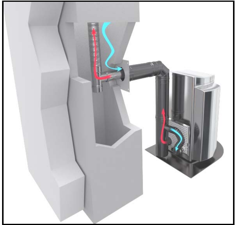
Figure 10 - Configuration rénovation de conduit existant avec prise air frais haute (poêles et chaudières à granulés)
