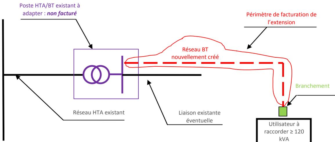
Lorsque l'Opération de Raccordement de Référence consiste à créer un nouveau poste HTA/BT, le périmètre de facturation de l'extension comprend les frais correspondant à la création d'un poste HTA/BT et son alimentation HTA, ainsi que la création du départ BT permettant de raccorder l'installation.
