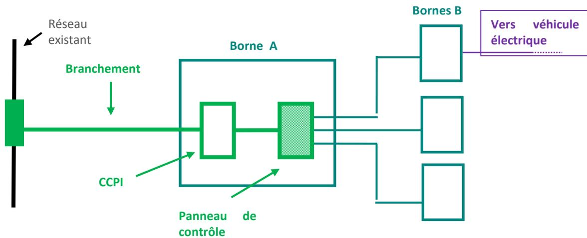
2. La partie du branchement logé dans la borne A intègre uniquement le panneau de contrôle.
