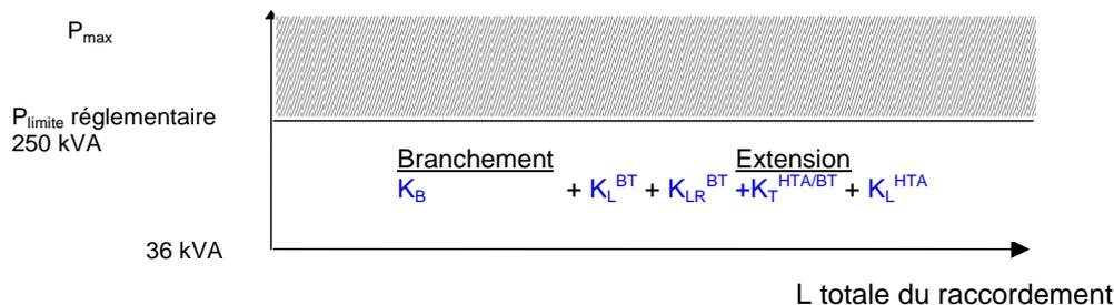
Figure 5 Composants de la facturation des branchements et des extensions
