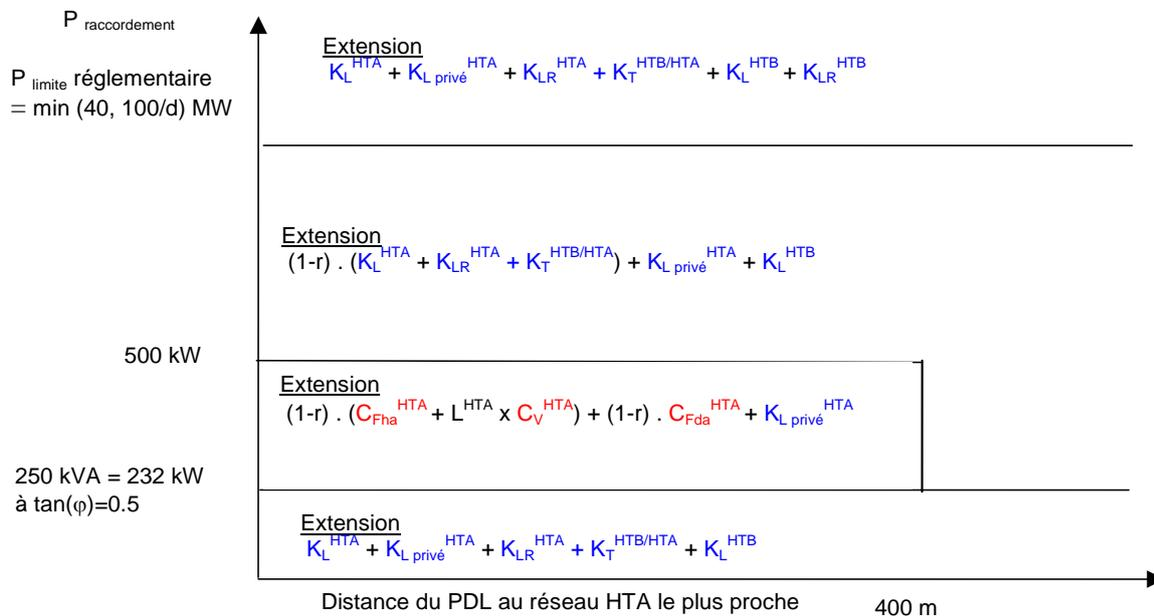
Figure 3 Composantes de la facturation des extensions HTA
