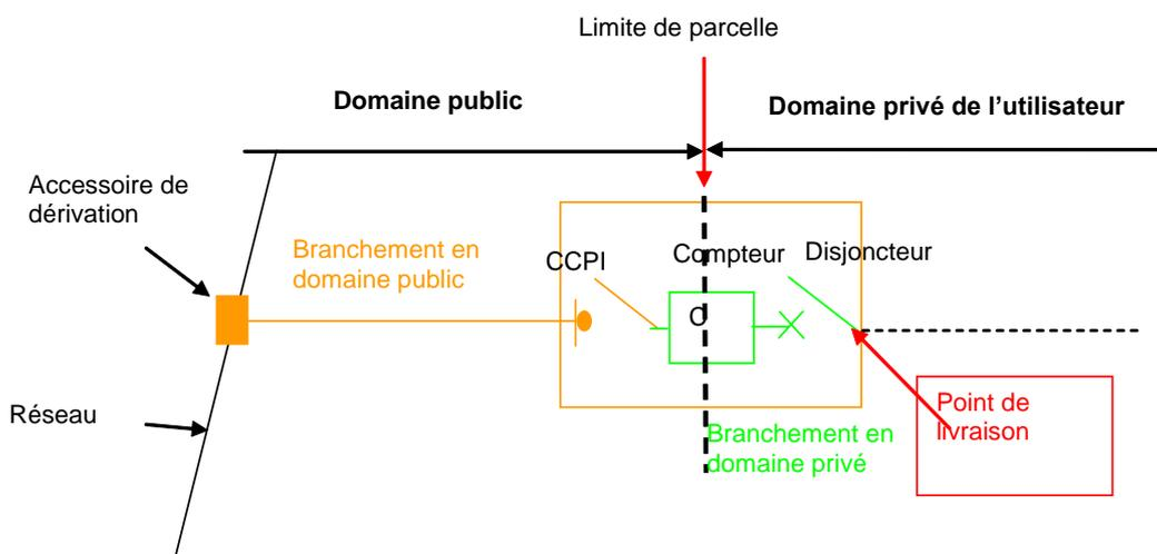
La liaison en partie privative est entièrement réalisée par le demandeur; elle ne fait pas partie des ouvrages concédés à Enedis et doit être conforme à la norme NF C 15-100.
